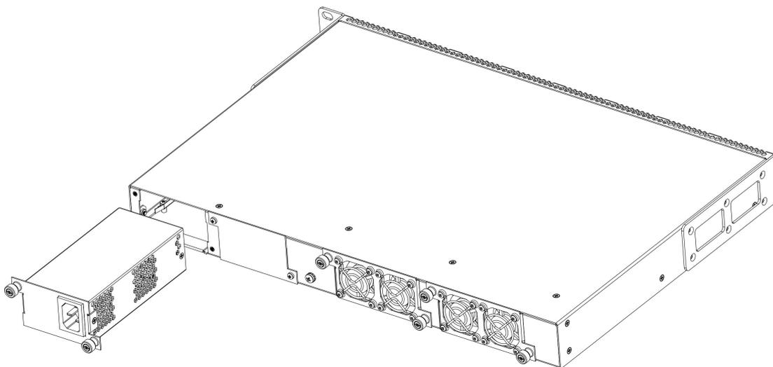
Рисунок 6 – Установка модуля питания в LTP-8(16)N(T)
