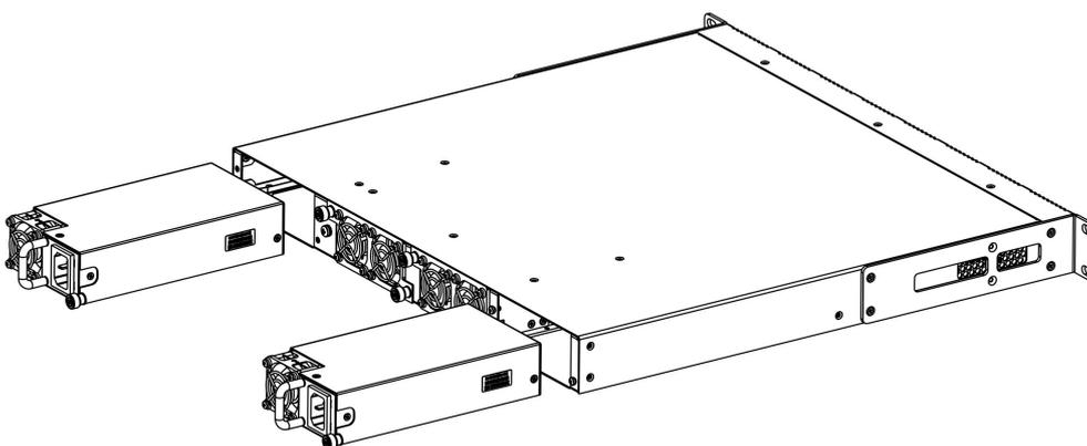
Рисунок 9 – Установка модулей питания в LTX-8(16)
