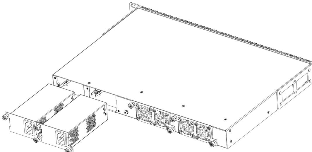
Рисунок 8 – Установка модулей питания в LTP-8(16)N(T)
