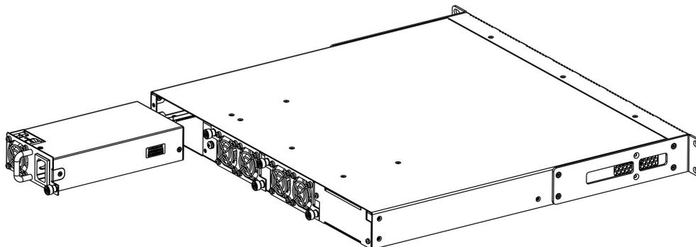
Рисунок 7 – Установка модуля питания в LTX-8(16)
