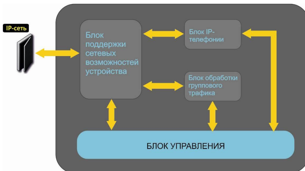
Рисунок 3 – Функциональная схема TAU-8.IP
